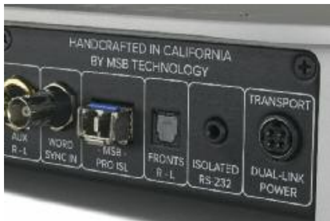
Dettaglio del retro della Reference Transport, l'ingresso del collegamento proprietario al Reference DAC è quello denominato Pro ISL.
