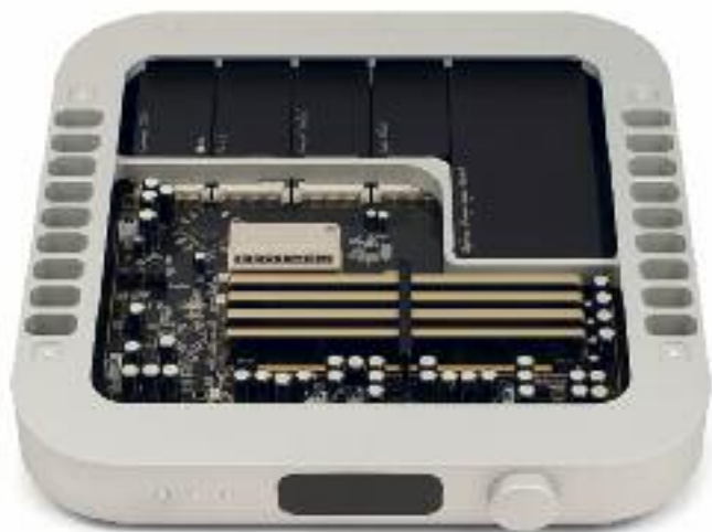
L'interno del Reference DAC brilla per ordine e composizione architettonica. Spiccano gli otto moduli ibridi.
